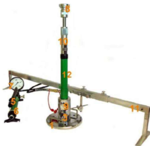
Rys. 1.2. Aparatura VSS z jednopunktowym pomiarem przemieszczenia płyty
